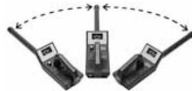
Escuche la intensidad de la señal y mire la mitad derecha del medidor.
