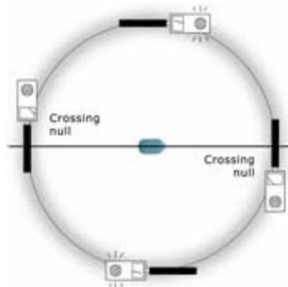
Acaba de identificar los dos "Cruce nulos" y la línea entre ellos indica el trazado de la línea en la que se encuentra el transmisor. Técnicamente, sólo podemos estar seguros de que esta línea es paralela al eje del transmisor, pero generalmente es así. Es seguro asumir que el transmisor es paralelo a la línea en ese punto, y asumiremos por el momento que la línea pasa recta por ese punto, a lo largo de la línea de los Nulos de Cruce.
