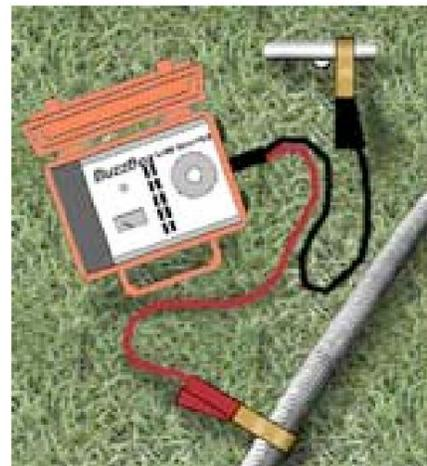
La técnica para localizar una línea energizada de forma conductiva es la misma que para la inductiva, así que sigue adelante y recorre la línea nuevamente para ver cómo funciona. En general, encontrará que la señal es más fuerte y distinta en el modo conductivo.
